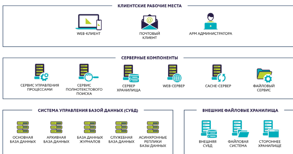
Рис 2. Компоненты платформы Docsvision
